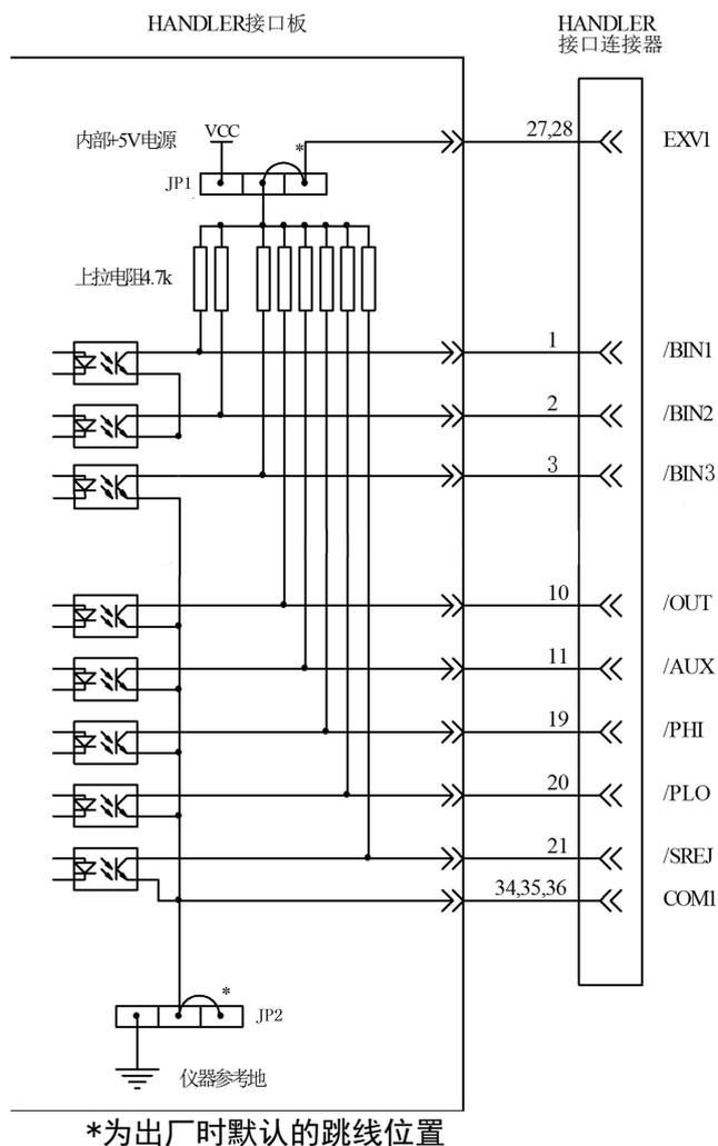
图 5-3 分选输出信号简化示意图
