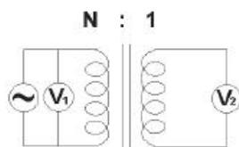
图 6—3 电压比法直接测量匝比
