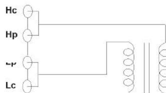
图 6—6 变压器绕组间电容测量
