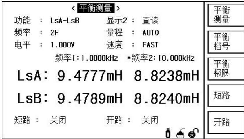
说明：在双频测量时，HANDLER 接口的比较结果只输出 BIN1、OUT 两个信号，BIN1 表示合格，OUT 表示不合格。
