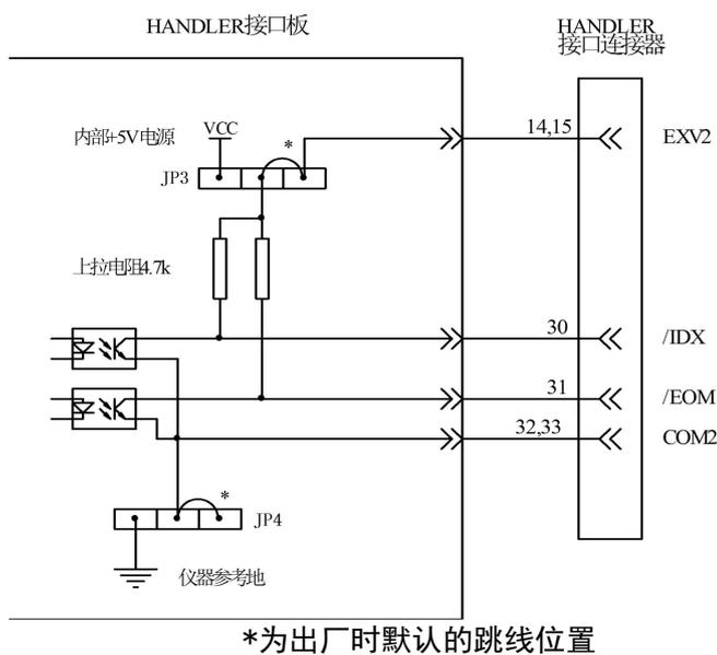
图 5-4 控制输出信号简化示意图
