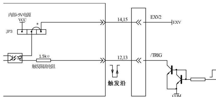
图 5-7 使用达林顿反向器驱动触发信号
