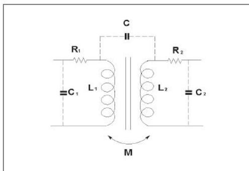
图 6—1 变压器及其参数示意
