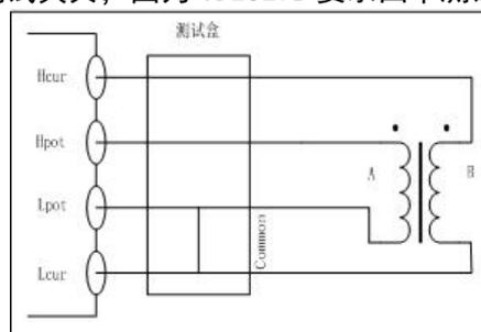
图 6—2 变压器测试连接示意图
