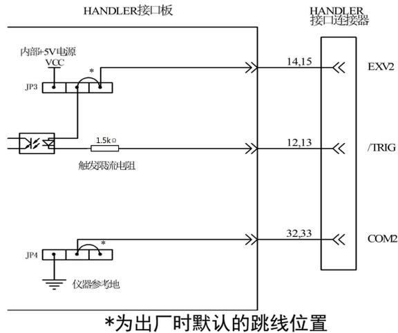
图 5-5 HANDLER 口触发输入信号简图
